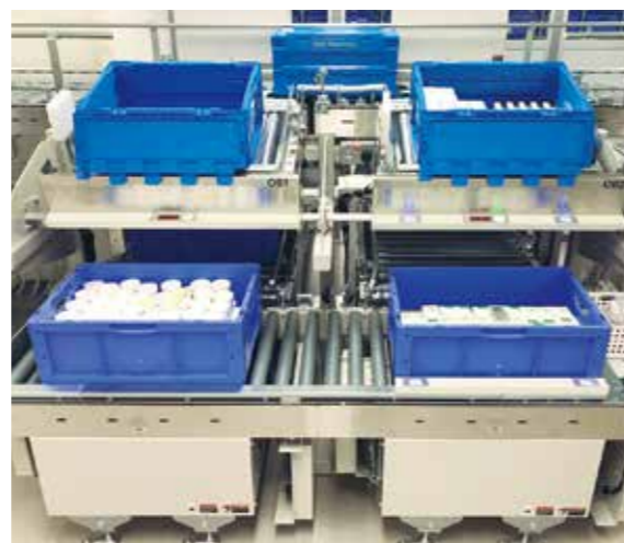
院内薬局には、グッズ・スーパーソンのピッキングステーションが6カ所設置されている。
