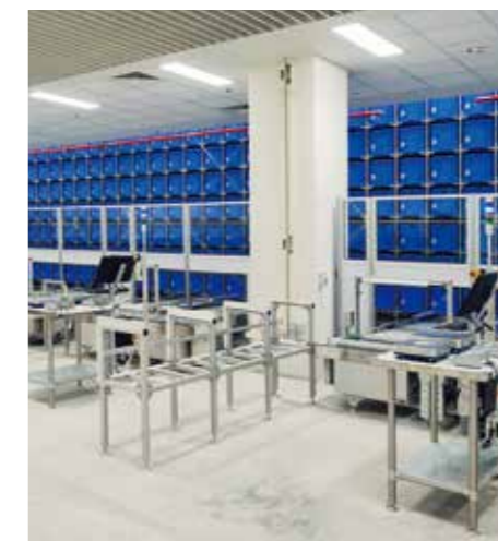
物品管理部のピッキングステーションでは、計量による検品を行ってから集品用コンテナに投入する。
