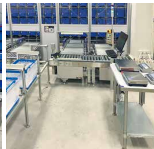
物品管理部のピッキングステーションでは、計量による検品を行ってから集品用コンテナに投入する。
