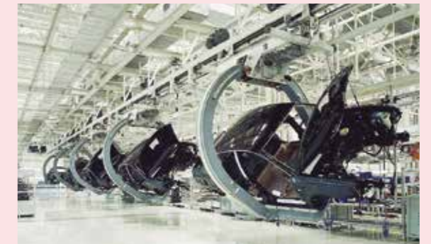
AFT Industries AGが納入したエレクトリックモノレールシステム。
