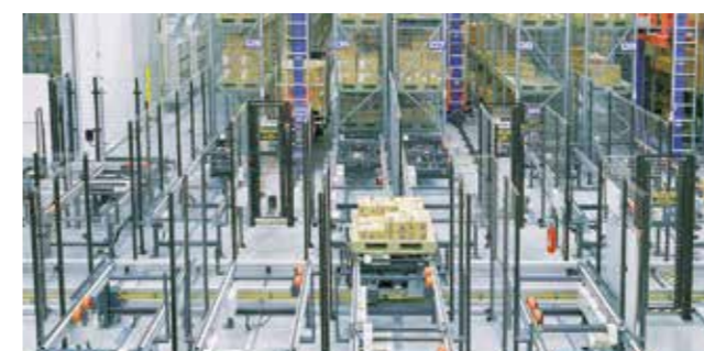
パレット入庫品は自動倉庫に一時格納後、デパレタイズロボットのステーションへ供給される。
