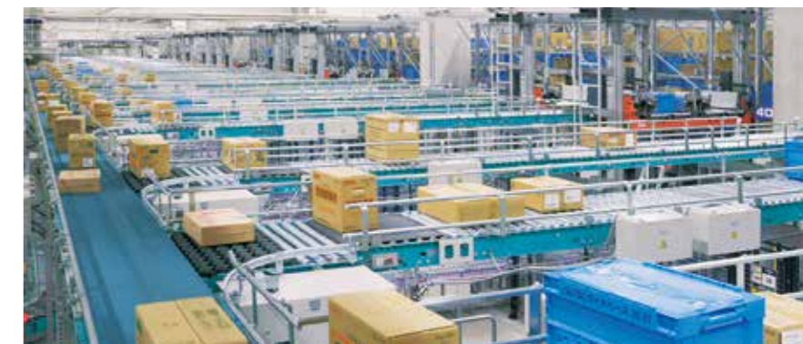
元梱単位の出荷、ロボットピッキング用の容器へ移し替えるための出庫などを行う元梱自動倉庫。
