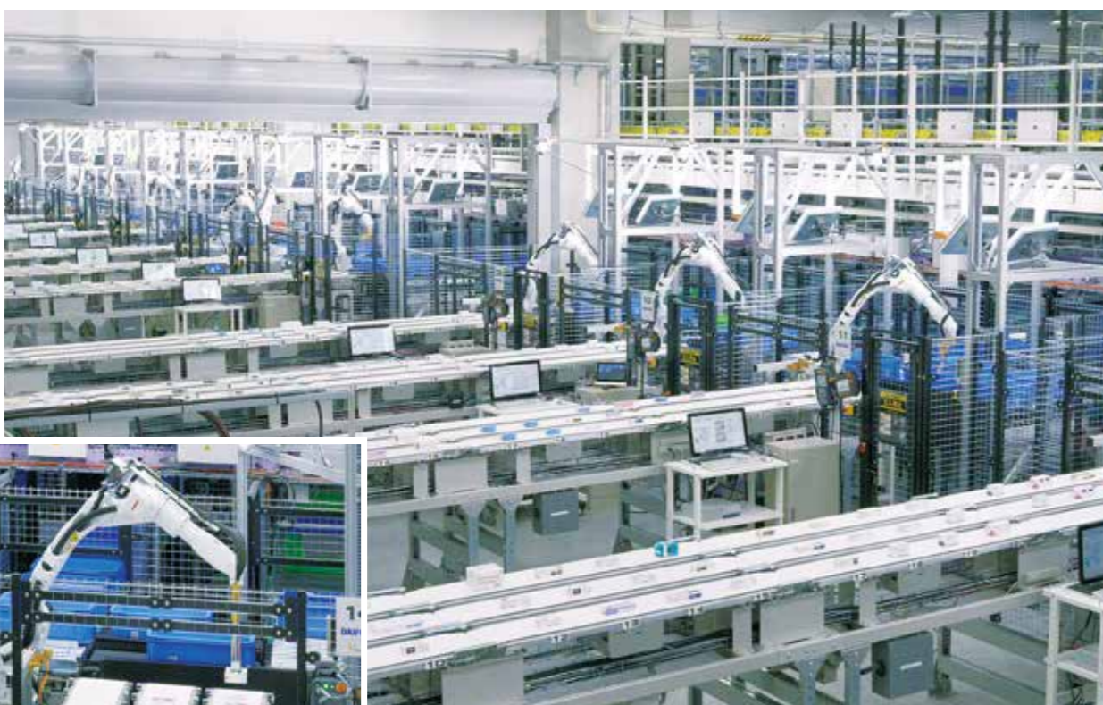
バラピッキングエリアでは、ロボット26基が1時間当たり1万5,000個をピッキングする。
