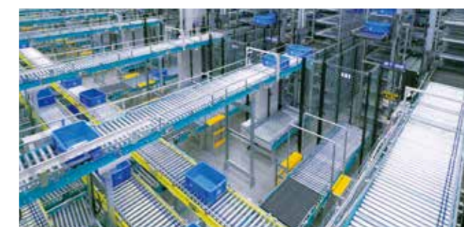
ピッキングした商品を保管するマージストレージでは、出荷用オリコンに詰め合わせるトレーがすべて揃うと出庫を行う。
