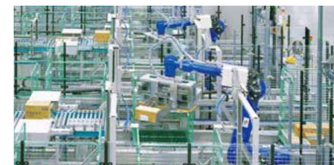
多様なサイズの元梱を、最適な積み付けパターンで出荷用のカーゴ台車に自動で積み付けるロボット。
