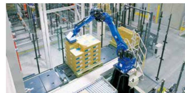
パレットから1箱ずつ元梱を降ろし、コンベヤに投入するデパレタイズロボット。
