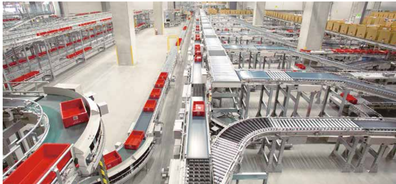
新センター内に張り巡らされたコンベヤは4,900m長。写真左は空コンテナプールライン、写真右は出庫ステーション。
