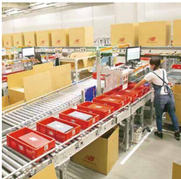
出庫ステーションは24間口。基本の1オーダーは1つの段ボールに12足詰め出荷する。オーダーが揃ったものから、バーコードスキャンによる検品を経て、順に梱包していく。出荷ボリュームに合わせ段ボールは5種類用意し、うち最も頻度の高いサイズは自動製函機で作成、その他のサイズは人手で作る。2台設置した自動封函機は、異なるサイズの段ボールでも対応可能。
