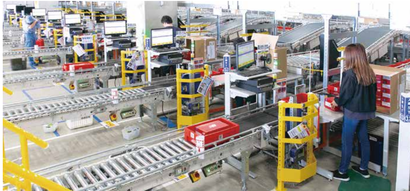
コンテナに商品ボックスを投入する入庫ステーションは20間口を設置した。コンベヤで搬送されてきた段ボール(12足入り)から商品ボックスを人手で取り出す。1時間当たり7,500コンテナに対応する。
