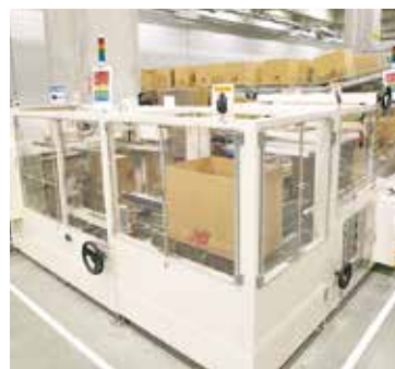
出庫ステーションは24間口。基本の1オーダーは1つの段ボールに12足詰め出荷する。オーダーが揃ったものから、バーコードスキャンによる検品を経て、順に梱包していく。出荷ボリュームに合わせ段ボールは5種類用意し、うち最も頻度の高いサイズは自動製函機で作成、その他のサイズは人手で作る。2台設置した自動封函機は、異なるサイズの段ボールでも対応可能。
