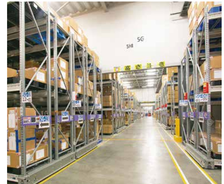
5階の在庫品保管エリアには計1万2,457間口の移動ラックを設置。フォークリフトでケースピッキングを行いパレットに積載後、4階まで下ろしていく。
