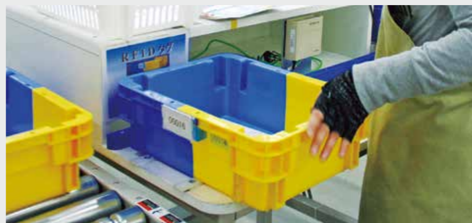
物流センターや倉庫などでのRFID活用が進んでいる。写真は通販用のピッキングラインのスタート地点で、集品コンテナに差し込んだRFタグとオーダーを紐づける様子。
