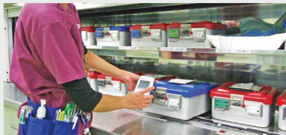
多くの医療機関ではバーコードを活用しているが、RFIDの方が扱える情報量が多く、情報の読み書きに要する時間が短い。バーコードはバックアップとして残しつつ、RFID導入で効率化を図っている。
