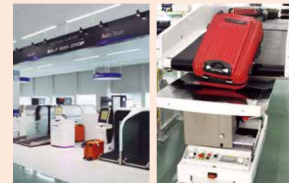
セルフバッグドロップはハイブリッド無人搬送車式手荷物検査システムとオートスキャンの2タイプを設置。デモの様子。
