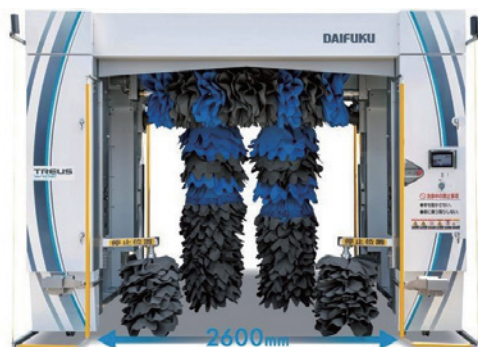
従来型よりも間口を拡大し、大型自動車の進入が容易に
