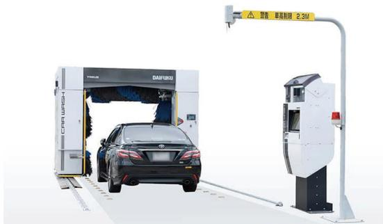
トレウスは、ドライブスルー洗車機の主力機種で、主にセルフのガソリンスタンドに設置されています。ブラッシングと同時にすすぎも行うことで、泡洗車の工程を従来の2.5往復から1.5往復へ削減して洗車時間の短縮、節水、節電につながっています。
