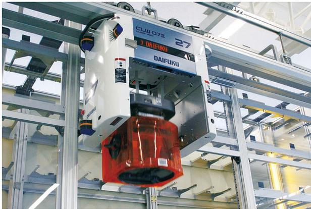
代表的なコア技術の一つ、非接触給電 (HID=High Efficiency Inductive Power Distribution Technology) によるモノレールシステムは1993年の開発以来、環境・安全にも貢献する次世代型搬送システムとして注目を集めてきました。自動車や半導体業界で採用され、高い評価を得ています。
