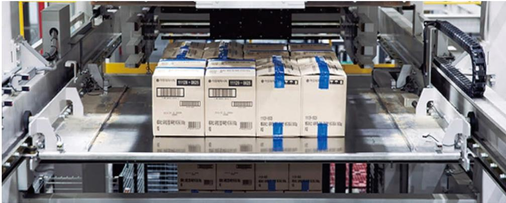
レイヤーピッキング装置は、パレットに段積みされたケースを層単位でピッキングし、コンベヤへ投入したり、他のパレットに積み付けたりします。主に飲料などの1箱あたりの大きさ・重さがある商品に活用され、1台あたり最大2,000ケース／時間の処理能力（約5名分の作業）を持ちます。単調で負荷の高い作業から、作業者を解放します。
