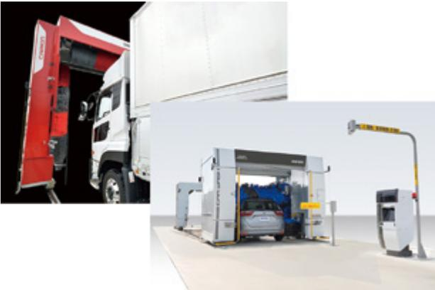
物流システムで培ったモノを動かす技術を洗車機にも応用しています。洗車を自動化することで、作業負荷を軽減するとともに、洗車時間を大幅に短縮することが可能です。また、洗車機は、一般的に自宅での手洗いに比べ水使用量を抑えることができるほか、油水分離槽で排水の油やゴミが処理されることにより、環境保護に貢献しています。当社グループでは、節水や省エネ機能の強化に取り組むとともに、植物由来原料を主成分とした生分解性に優れた液剤や樹脂製の水タンクを採用し長寿命化を図るなど環境配慮に努めています。
