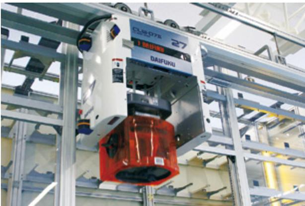
代表的なコア技術の一つ、非接触給電（HID=High Efficiency Inductive Power Distribution Technology）によるモノレールシステムは1993年の開発以来、環境・安全にも貢献する次世代型搬送システムとして注目を集めてきました。自動車や半導体・液晶業界で採用され、高い評価を得ています。
