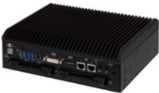
高性能 CPU をファンレスで運用可能とした産業用ボックスコンピュータです。TDP35W の CPU を搭載し、ヒートシンク放熱技術により回転駆動部品を排除した設計。消耗品のファンをなくし筐体サイズを小型化、エネルギー消費も抑え、従来比で消費電力を 42%、重量を 31% 削減しました。
