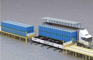
ドライブスルー型トラックステーション「TRTS」は、トラックへの荷積み・荷降ろしを自動で行う設備です。フォークリフトを使わずに荷積み・荷降ろしすることで、ドライバーの作業負担を軽減。トラックの待機時間も通常約40分から約10分へと大幅に短縮できます。また、トラックの運行台数やドライバー人数の最適化により稼働率が向上します。
