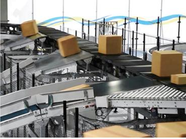
クロスベルトソーターは、ベルトコンベヤを搭載した台車をつないでループ状に構成した高能力ケース仕分け装置です。ベルトコンベヤへの給電は台車車輪の回転を利用し、発電モーターから行うことで高効率に電力を供給。従来より消費電力を削減しました。
