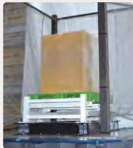
揺れによる荷崩れの様子(上)。減崩ストッパーの装着や荷物にフィルムを巻くなど、さまざまな防止策で効果を確認
