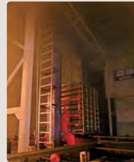
サイズ別にダンボール梱包された魚を、凍結庫に自動で格納し、鮮度を保つために-35℃まで急速冷凍する自動倉庫システムです。世界で初めて魚の急速冷凍に自動倉庫を活用して、無人化を実現しました。
