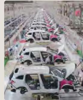
自動車生産の組立ラインにおいて、作業者が作業しやすい高さに車体を昇降させることができ、作業者は伸びたり屈んだりする必要がなくなり、体への負担を大幅に軽減。加えて、エンジンや大物部品などの組み付け精度の向上にも効果を上げています。
