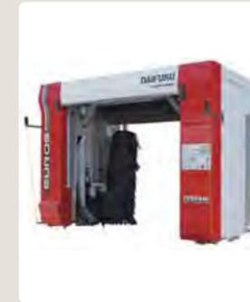
フルサービスSS向けの門型洗車機。高性能センサー搭載の垂直昇降式トップブラシの採用やリヤ部の乾燥力を高めたことにより、洗浄・乾燥性能を向上させました。また、洗車時間も85秒/台と業界最速、レール長も業界最短の7.8mを実現しスペース効率を向上させました。
