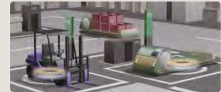
非接触給電「HID」の技術を活用したワイヤレス給電システムを構築。フォークリフトや無人搬送車などのバッテリー充電、搬送装置の移動中給電をケーブルレスにするなど、自動車、半導体・液晶、医薬品業界など幅広い分野で採用されています。
