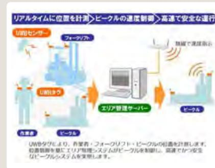
経済産業省と新エネルギー・産業技術総合開発機構(NEDO)による「生活支援ロボット実用化プロジェクト」の一環として、「エリア管理システム」を開発。2014年2月、生活支援ロボットの国際安全規格「ISO 13482」の認証を世界で初めて取得しました。同システムは、従来に比べ約3倍の200m/分で走行する高速ビークル(写真右)の安全性を高めるために開発したものです。UWB(Ultra Wide Band:超広帯域無線)による位置計測で、配送センター内の作業員やフォークリフトの位置をリアルタイムに計測し、ビークルの走行速度をコントロールすることで安全を確保します。
