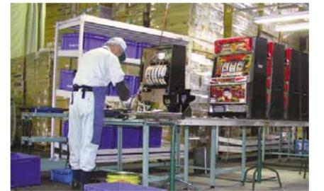
解体作業場に設置した「グッセルフ」棚を傾斜させ「FSコンテナ」内の視認性を高めている
