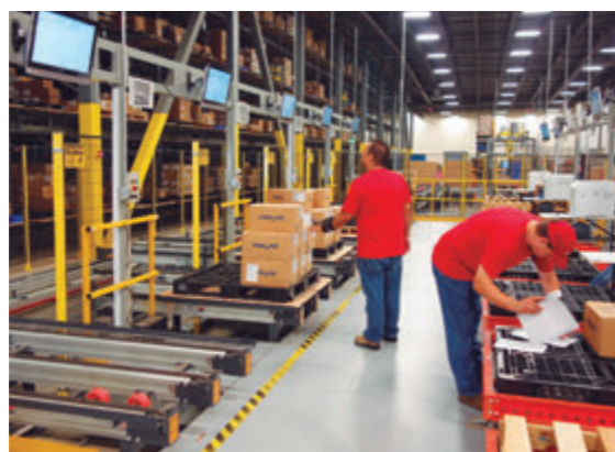
左側が自動倉庫に直結したピッキングステーション。ピッキングした製品は右側の出荷用のパレットに移載する。
