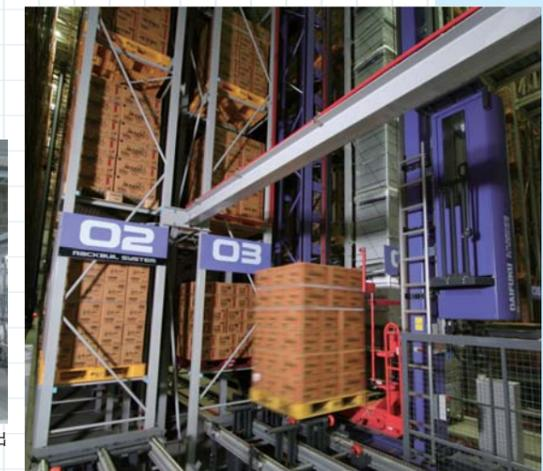
スタックークレーン5基、格納数1万1,060パレットのRB。幅22m、高さ31.5m、奥行120mの規模。
