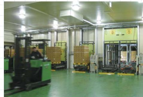
庫内温度-35℃のCS。スタックークレーン4基、格納数1,976パレットの規模。
