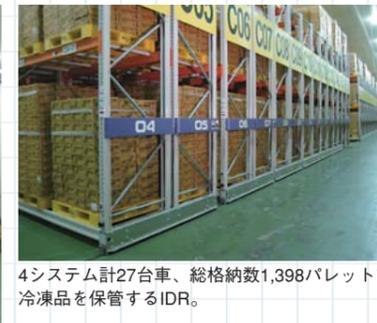
4システム計27台車、総格納数1,398パレットで冷凍品を保管するIDR。
