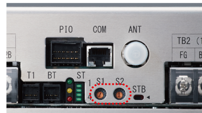
電圧はロータリースイッチで簡単に設定可能
