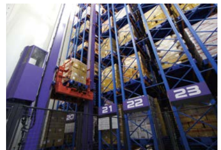
タイの食品メーカーに納入した冷凍自動倉庫
