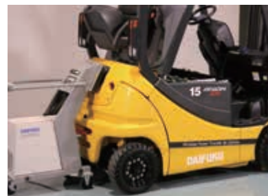
(写真2) 電動フォークリフト向け非接触充電システム「D-PAD」
