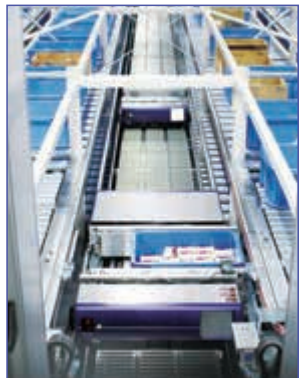
ピッキング自動倉庫
