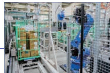
ケース積付ロボット さまざまな荷姿のケースをスピーディーに積付け
