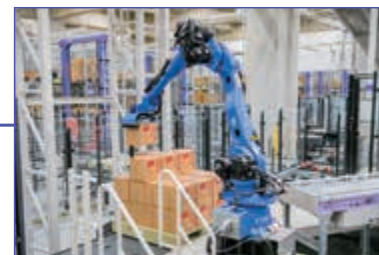
デパレタイズロボット 自動倉庫から出庫されたパレット上の段ボールケースをピッキング
