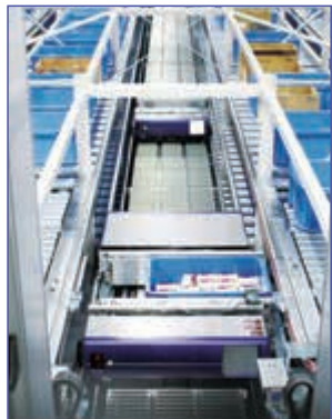
ピッキング自動倉庫 ピッキングを行うロボットにタイムリーに商品を供給
