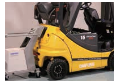
(写真2) 電動フォークリフト向け非接触充電システム「D-PAD」
