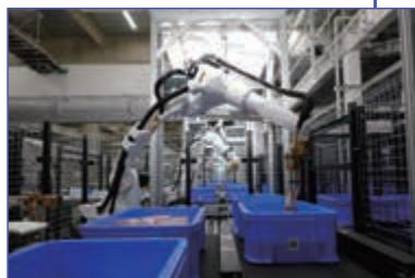
ピッキングロボット サイズや重さが異なるピース品を正確にピッキング
