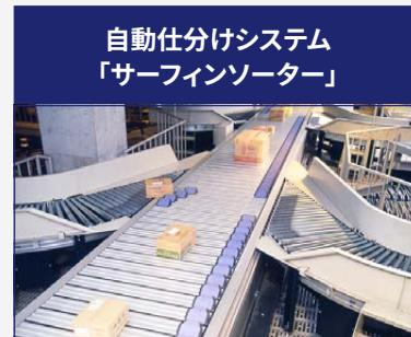
不定形・長尺物など多様な荷姿に対応できる自動仕分けシステムです。ソフトタッチのスライドシュー方式で、荷傷みの心配もなく確実な仕分けが可能です。
