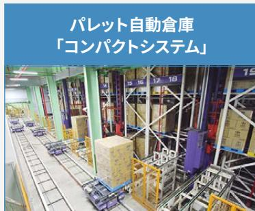
パレット単位の製品や部品を自動搬送し高層ラックに保管する、ユニット式の自動倉庫です。高さ方向を有効利用することで、格納効率を高めることができます。
