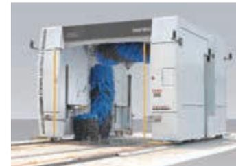
**大型車両専用洗車機**
