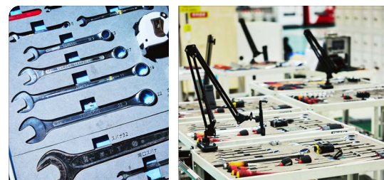
工具を元の位置に戻すための「姿置き」(自社製)。各製品の組立手順に合わせて設計
