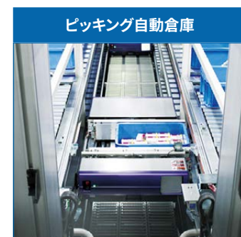
ピッキング自動倉庫 ピースピッキングを行うロボットに タイムリーに商品を提供
