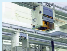
半導体工場向け搬送システム
