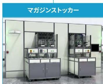
ボンディング\*材料を供給および収納するための容器（マガジン）の格納棚
