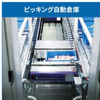
ピースピッキングを行うロボットにタイムリーに商品を供給
