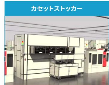
工程間でウエハを移送するための容器（カセット）の格納棚
