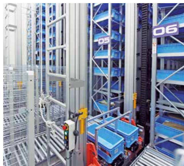
冷凍環境下では業界でも珍しいケース自動倉庫「ファインストッカー」を導入し、ピースピッキングにも活用している。
