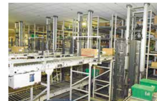
出荷準備の整った商品は、シャトルラックMで一時的に保管する。
