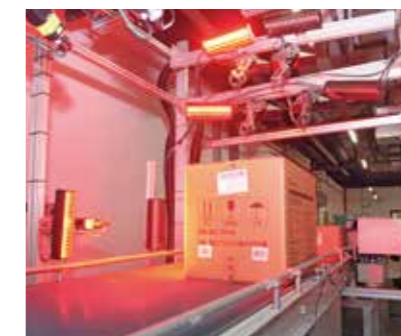
5面スキャン装置では、出荷する商品の医薬品電子監視コードを読み取り、トレーサビリティ機能を向上。
