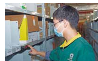
デジタルピッキングシステム（1,486表示器）では、流動棚で高頻度出荷品を、中量棚で低頻度出荷品を保管している。
