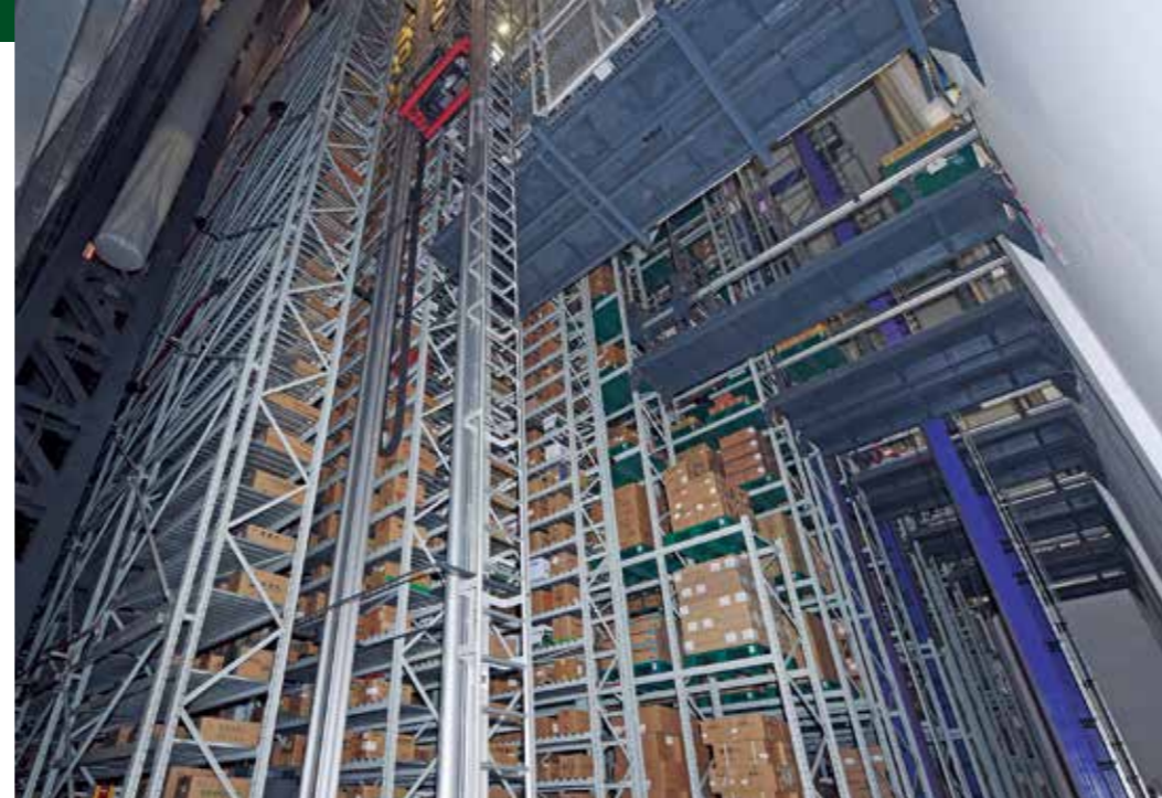
写真手前は、ケース自動倉庫（高さ20m、スタッカークレーン2倉庫（高さ24m、スタッカークレーン10基、格納数1万5,600パ
