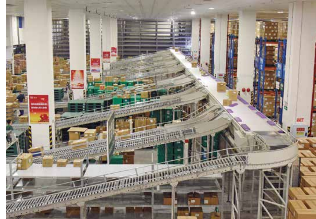
ピッキングされた商品は高速自動仕分け装置（16シュート）に搬送され、出荷方面別に仕分けられる。
