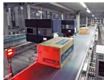
レイヤーデパレタイザーでは、パレットから1層ずつ切り出しケース単位にする。
