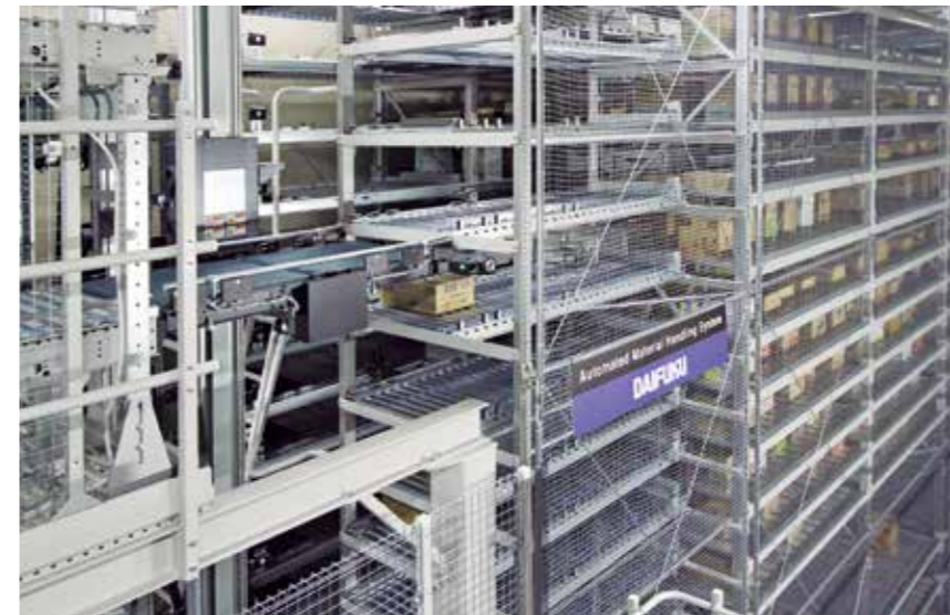
デパレタイズされたケースは、出荷するまでシャトルラックMで一時的に保管される。
