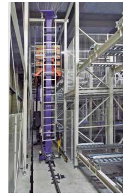
5基のスタックークレーンで、出荷パレットをステージングレーンに運ぶ。
