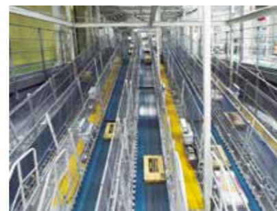
3階でケース単位にデパレタイズされた後、2階のシャトルラックMに搬送される（写真上・下）。
