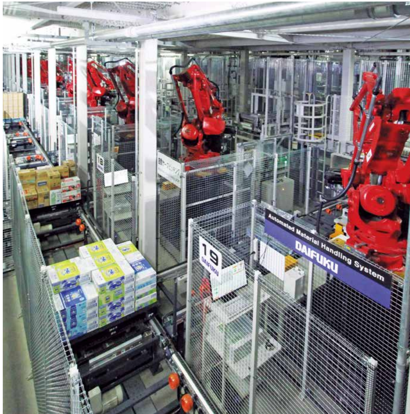
21台の混載パレタイジングロボット。パレットへの積み付けを効率よくするための積み付けパターンを算出して、積み付け順に供給する。
