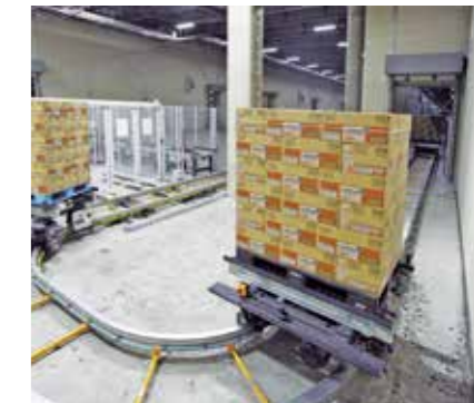
出荷パレットを高速搬送台車で出荷エリアへ搬送する。
