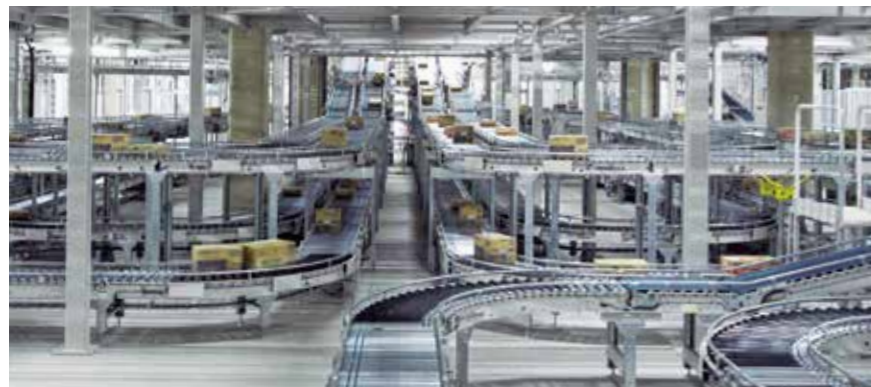
3階と2階の間はケースコンベヤで搬送。
