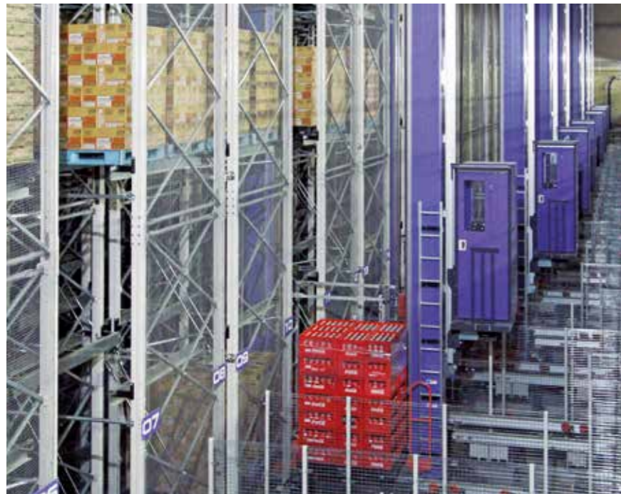
同社最大規模の保管能力を持つパレット自動倉庫は、6万パレットを格納できる。
