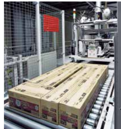
レイヤーデパレタイザーでは、パレットから1層ずつ切り出しケース単位にする。
