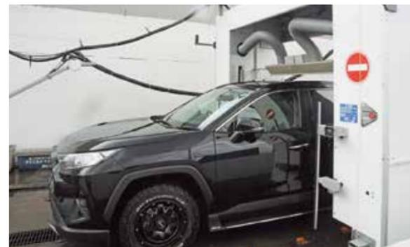
洗浄機と乾燥機が完全に分離し、前部を洗い終わると乾燥も同時に行っていくことで、洗車時間を短縮している。
