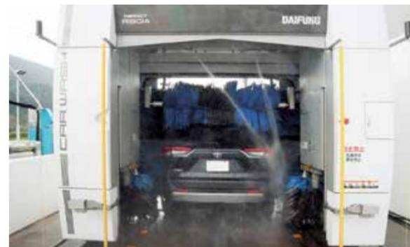
洗浄機には車形装備品自動認識システム「シェイプ・ナビV」を備え、車両形状を正確に認識することで、最適なブラッシング圧で洗浄する。
