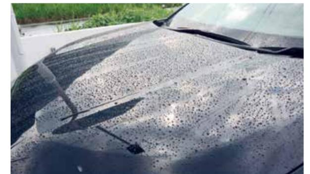
高密度ガラス系コーティング「プロストコート」を施した車体表面は、流水性に優れ、雨による汚れも付着しにくい。
