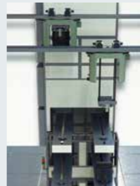
多階層化の進む工場に対応する 階間搬送装置「ジップタワー」。
