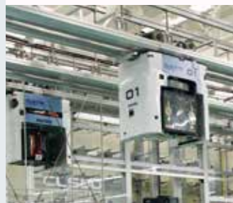
各製造装置を結ぶ天井走行式搬送システム「クリーンウェイ」。ワイヤレス給電システム「HID」の給電範囲を広げ、より効率的な電力供給を実現。
