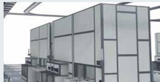
微細化に対応し、ウエハを保管する容器へ窒素の注入を行うことでウエハの劣化を防止する「窒素パージストッカー」。
