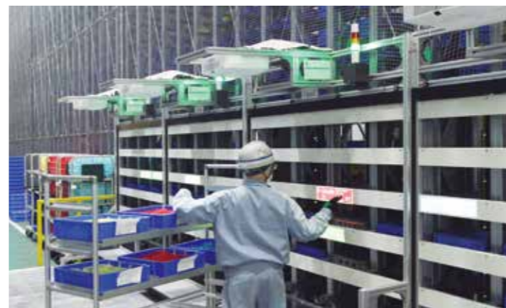
ング対象の間口とカート内のケースの色を対応させて効率化している。
