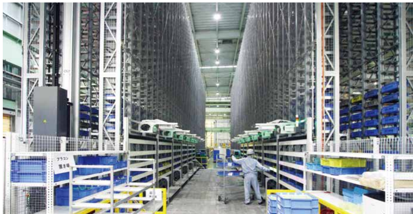
ケース自動倉庫「ファインストッカー」は最大7,904ケース格納可能。ラック側面をピッキング間口（計240間口）にし、プロジェクションマッピング技術を活用した作業指示を行う。ピッキ
