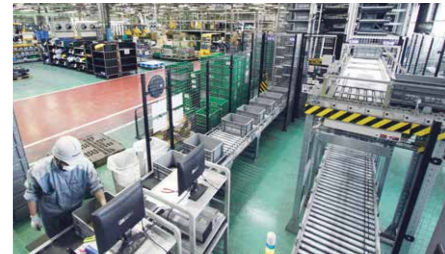
「シャトルラックM」は、保管効率を高めるため奥行き2列に保管するダブルディープ方式を採用し、最大2,880ケースが格納可能。在庫の入庫と、ピッキングするコンテナの出庫・再入庫が同時並行で行える。
