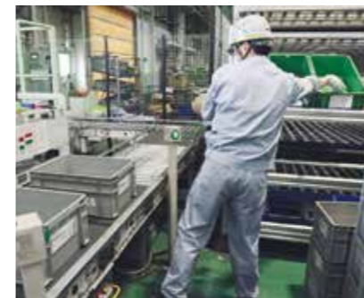
出庫コンベヤをコの字にレイアウトして、定位置でのピッキング作業を可能にしている。
