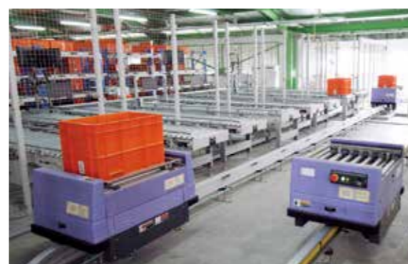
2階の出入庫口では、ループタイプの高速搬送台車3台で仕分けを行っている。
