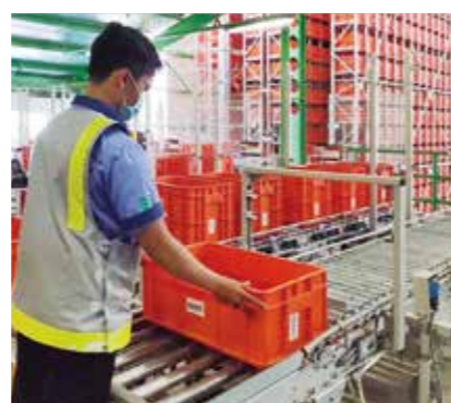
ピッキングが済んだコンテナは自動倉庫に戻される。
