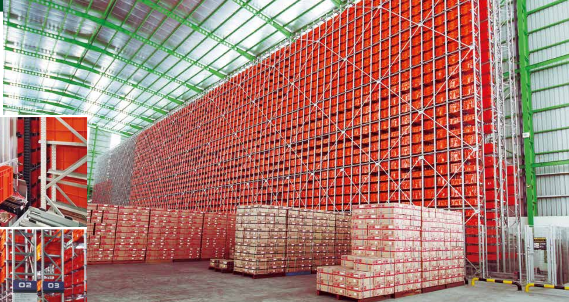
高さ15m、長さ66mのケース自動倉庫。二輪車のメインパーツに加え、バイク用ウエアやグローブなども保管している。
