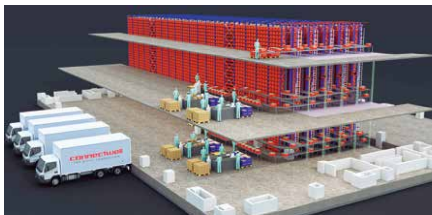
自動倉庫は1~3階吹き抜けで、各階に入庫口・ピッキングステーションを設置。
