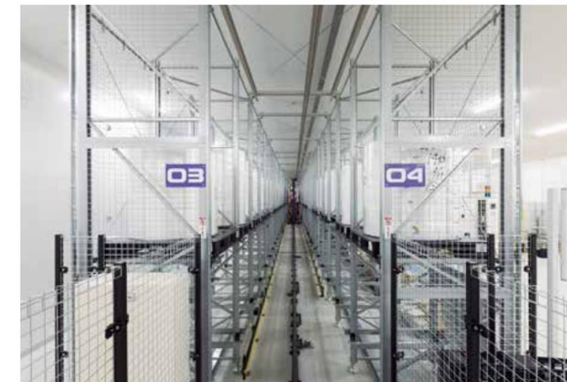
資材倉庫のパレット自動倉庫。ロール状の接着剤や包装用のラベル、フィルムなどの資材を一時保管し、生産ラインへ供給する。使用途中の資材を再入庫し、在庫を管理する機能も付加。
