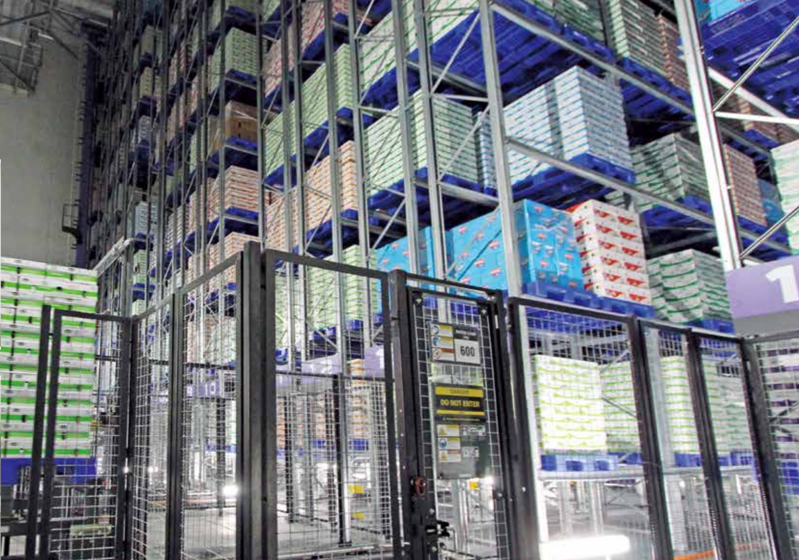
3,520パレット)。入出庫設備には自走式電動台車を備え、入出庫口の開閉を自動化し庫内温度の上昇を最小限に抑えている。入庫情報はWMSに登録して、情報に基づいた入庫ラベルを
