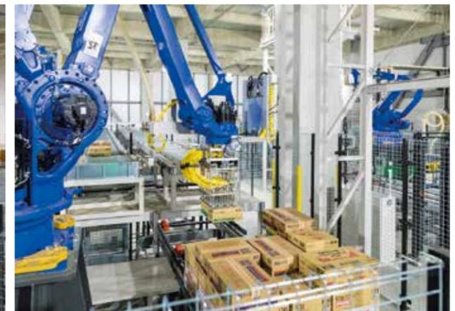
ロボットハンドの先に取り付けられた多数の吸着パッドが、上部から荷物を吸い上げ把持する。商品の大きさや重さに合わせて速度調整などを行う。
