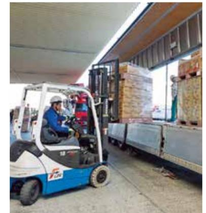
パレット積みすることで荷積みおよび荷降ろし時の作業負荷を軽減している。
