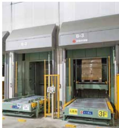
入荷した商品は人手でバーコードを読み込み、入庫ラベルを定められた位置に貼付。その後垂直搬送機を経て、物流特性に合わせた最適な場所で保管される。
