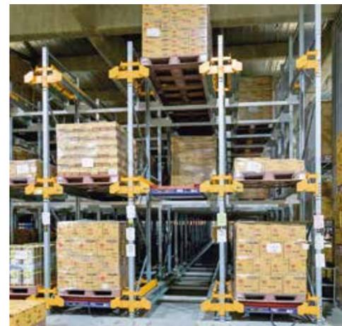
高頻度・大ロット出荷品を保管する「シャトルラックL」を設置。シャトル台車が60m/分の速度で、取り口に自動搬送する。
