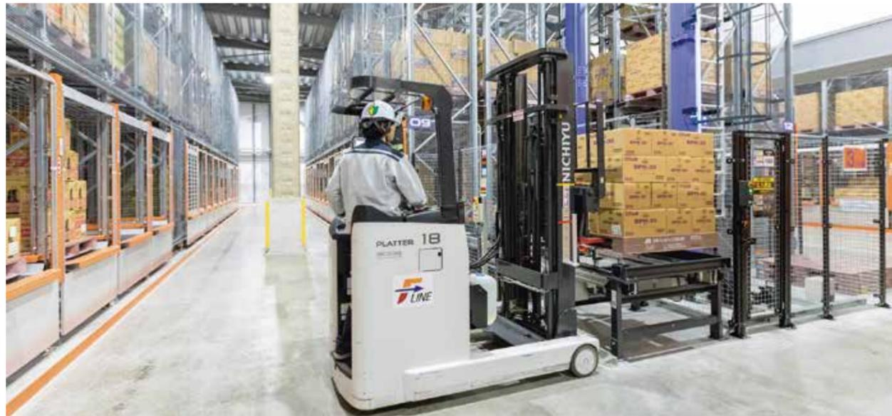
高頻度・中ロット出荷品の保管およびケースピッキングにパレット自動倉庫を活用している。最大保管数は1,464パレット。ダブルディープ方式を採用し、ピッキングする商品がなくなっても間口奥からすぐに商品が補充できる。
