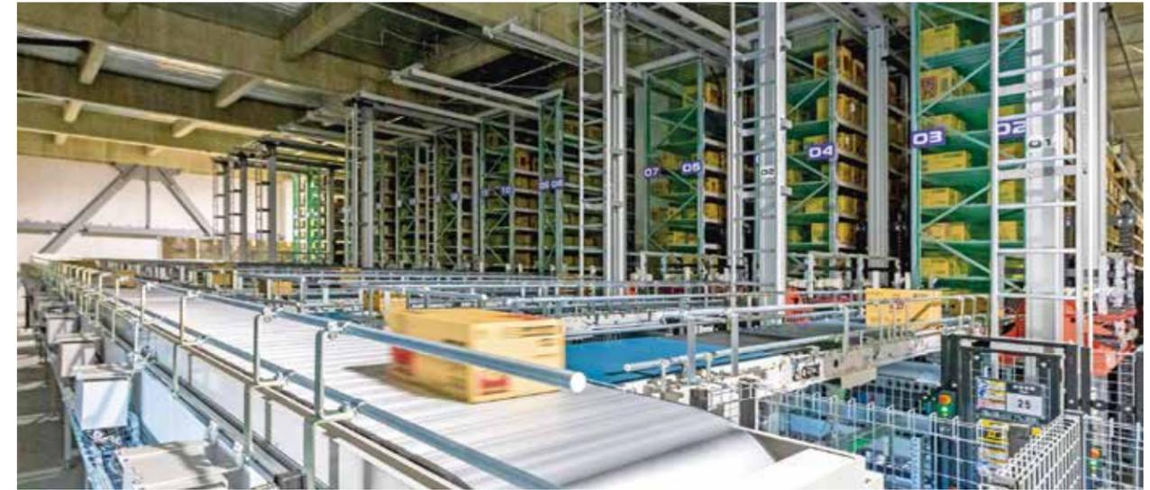
デパレタイズしたケースを一時保管するケース自動倉庫。パレタイズを行う際は4台のロボットに対して積み付け順にケースを供給する。クレーン速度200m/分で、1基のクレーンで同時に2ケースの入出庫が可能。
