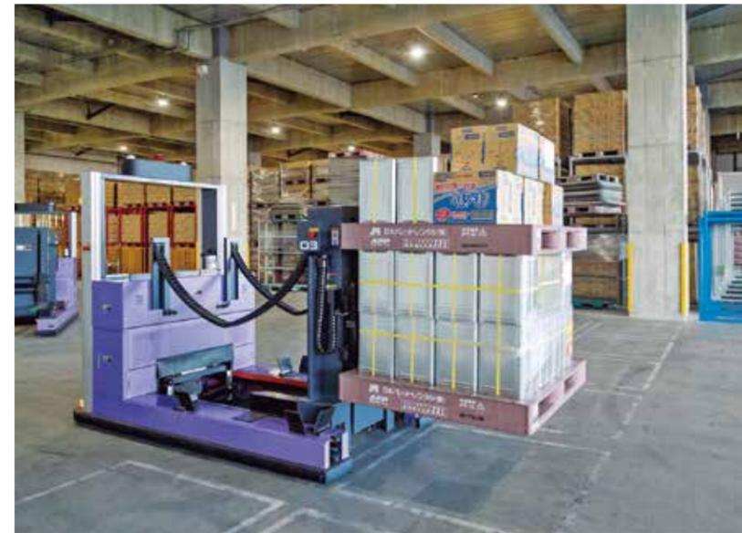
1階には無人搬送台車が、各フロアから垂直搬送機で降ろされたパレット単位の荷物を荷さばきエリアまで搬送する。レーザーガイドとスポットマグネット方式を併用し、充電も自動で行う。
