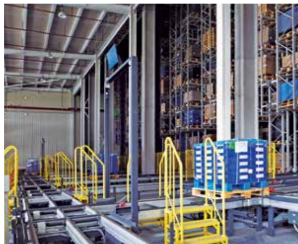
出荷する製品は、チェンコンベヤで3カ力所ある出庫ステーションに搬送される。
