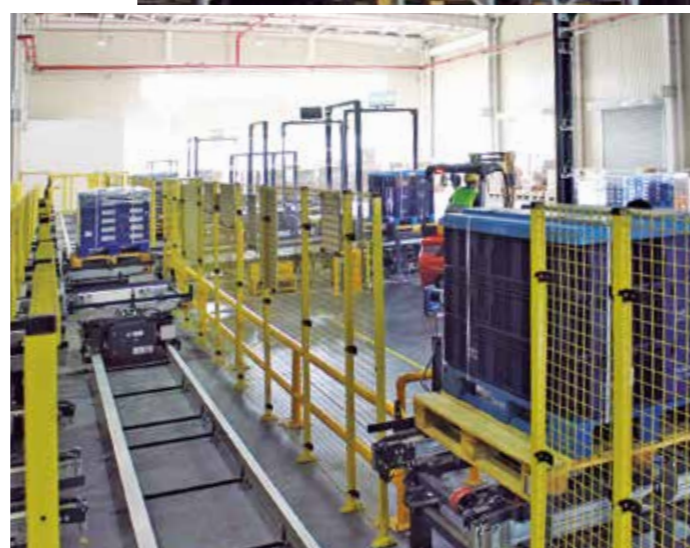
天井空間を最大限に生かした高さ24mの自動倉庫（スタッカークレーン8基、格納数1万2,000パレット）。入庫側にはデュアルタイプの高速搬送台車を備え、処理能力を高めている。
