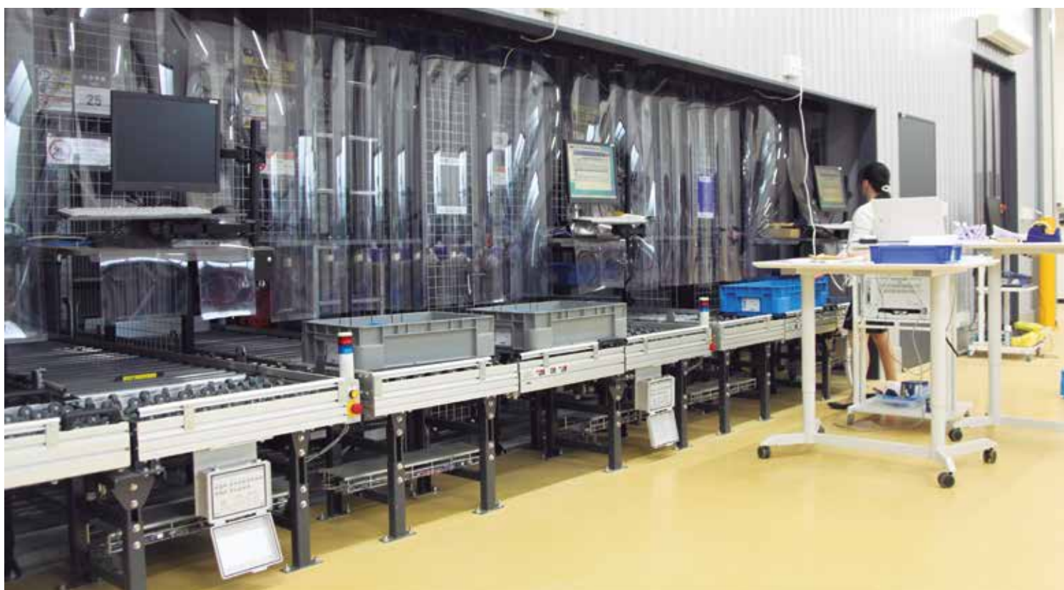
ケース自動倉庫「ファインストッカー」の入出庫口。スタッカークレーン3基を備え、格納数は7,644ケース。
