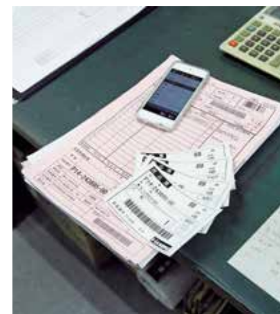
現品票ラベルをスマートフォン端末でスキャンし、生産管理システムに情報を登録する。
