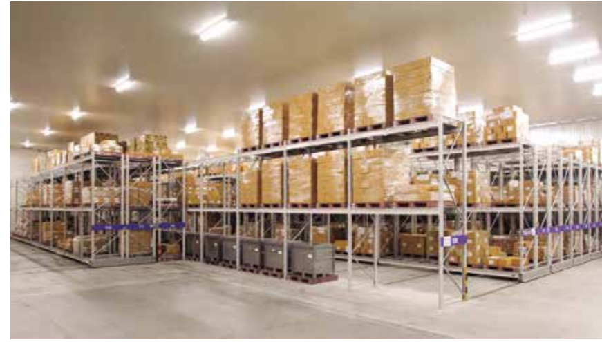
北埼玉支店では保管効率を高めるため、冷凍(-25℃)、冷蔵(4℃)、定温(15℃)の各温度帯で移動ラックを広く活用している。
