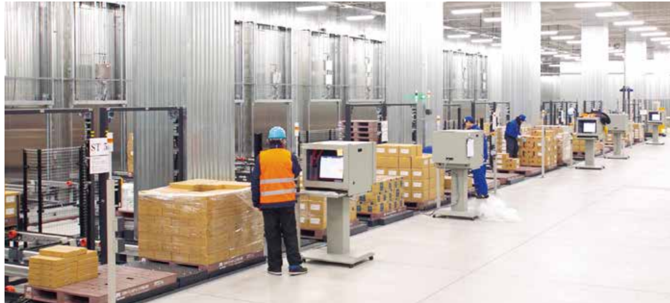
6カ所あるピッキングステーションでは、作業者は定点ピッキングが行えるため効率的。また取扱物量や作業者数に応じて、ピッキングステーションの稼働数を増減できる。
