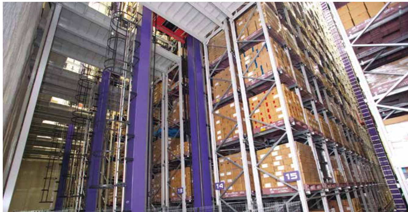
冷蔵環境(4℃)には7,168パレットを格納できる自動倉庫を導入、8台のクレーンで入出庫を行う。冷凍環境(-25℃)には格納数4,030パレットの自動倉庫を採用している。
