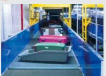
ベルトコンベヤを用いた手荷物の一時保管用ストレー
