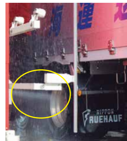
高圧で水を噴射する下部洗浄装置がトラックの足回りの汚れを洗い落とす。
