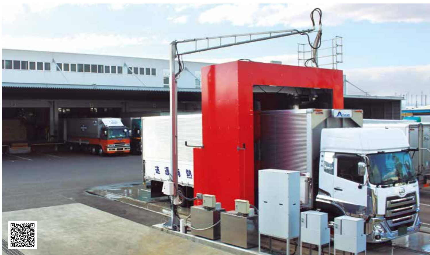
本社敷地の一角に設置している大型車両用の門型洗車機「カミオン カスタム」。洗車機本体は10tトラック1台を業界最速、最短3分55秒で洗えるため、キャブの手洗いや水滴の拭き取りを含めて約30分で終わることができる。（QRコードからは大型洗車機の製品情報へアクセスできます）
