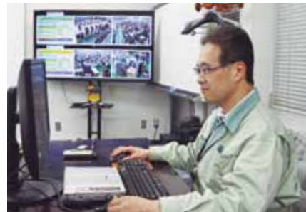
工程の“見える化”を実現したアンドンシステム。生産状況を現場だけでなく、オフィスからもリアルタイムに把握できる。インターネットを通じて、世界中どこからでも確認できる。
