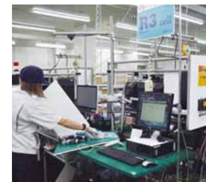
セル台車に人感センサーを設置し、各セルの稼働時間や稼働率をリアルタイムに把握している。
