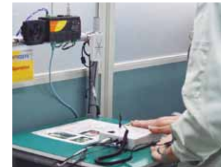
作業者の静電気チェック(左)、トルクドライバーのトルク確認(右)などにも、CONPROSYSを活用する。RFIDリーダーで社員IDを読み取り、計測結果を作業者にひも付けることで、厳格な運用を行っている。
