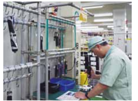
作業者の静電気チェック(左)、トルクドライバーのトルク確認(右)などにも、CONPROSYSを活用する。RFIDリーダーで社員IDを読み取り、計測結果を作業者にひも付けることで、厳格な運用を行っている。
