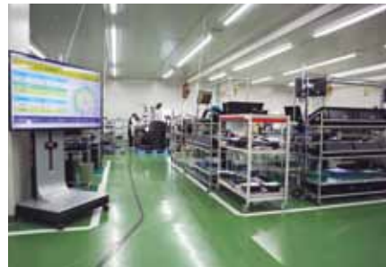
工程の“見える化”を実現したアンドンシステム。生産状況を現場だけでなく、オフィスからもリアルタイムに把握できる。インターネットを通じて、世界中どこからでも確認できる。
