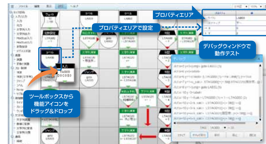
機能アイコンをツールボックスからドラッグ&ドロップするという直感的な操作でさまざまなタスク処理を組み込むことができる。専門知識や特別な開発環境は必要ない。
