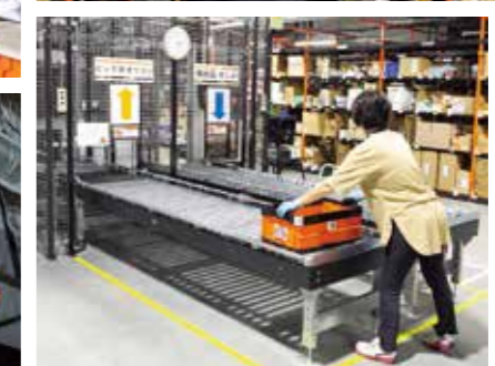
(写真上)行別仕分けを採用することで集約ピッキングが可能に。(写真下)ピッキングした商品はまとめてオリコンに投入して次のプロセスへ。
