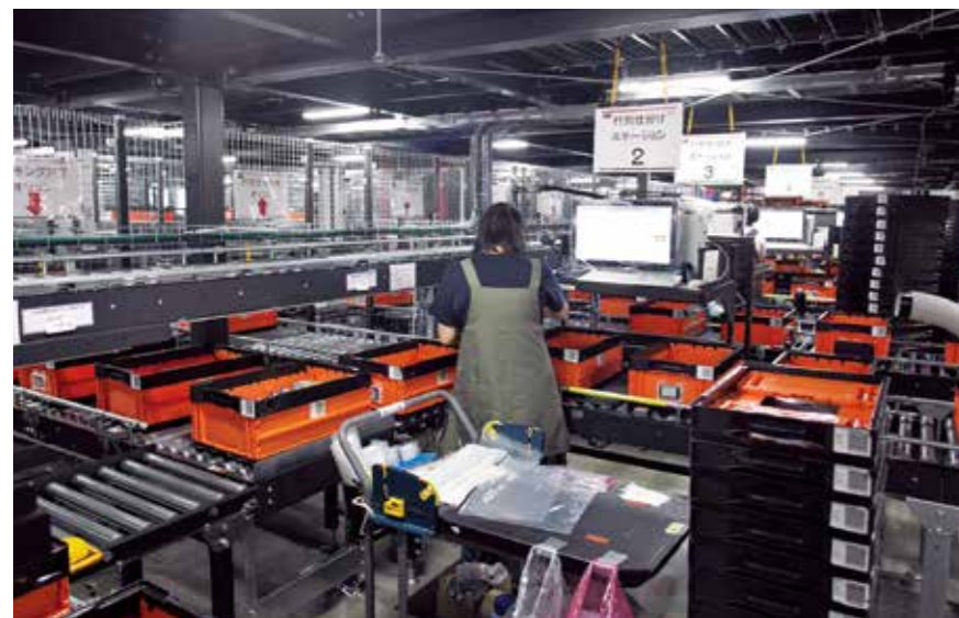
集約ピッキングされた商品は、行別仕分けステーションでオーダー行別に行った仕分け作業を行う。
