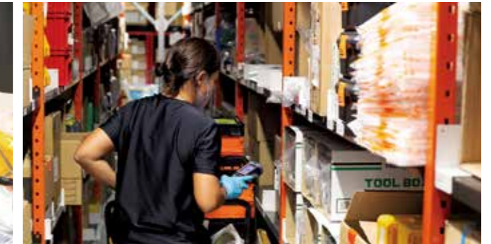
(写真上)行別仕分けを採用することで集約ピッキングが可能に。(写真下)ピッキングした商品はまとめてオリコンに投入して次のプロセスへ。
