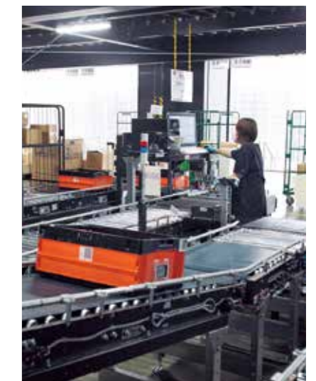
6カ所の荷合せステーションで、伝票行別に仕分けられた商品を納品先別に荷合わせする。
