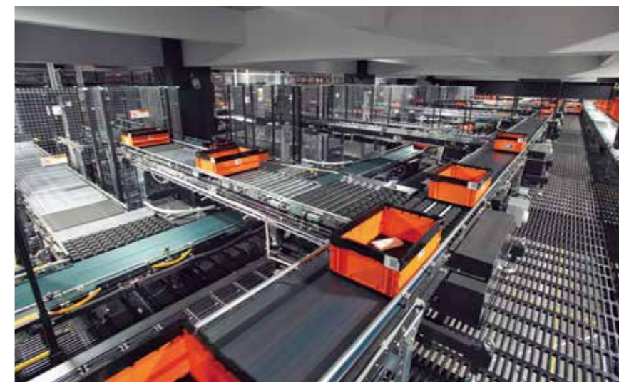
シャトルラックMでは行別仕分けした商品や出荷待ち商品を最大4,200オリコン一時保管し、最適な順序で荷合せステーションへ商品を供給する。
