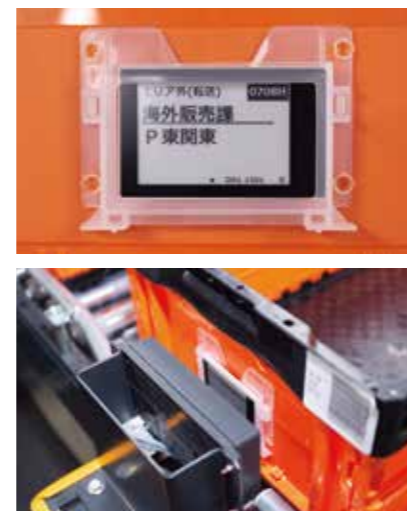
オリコンの中身の情報を示すために電子ペーパーを採用。従来はバーコードで管理していたが、ラベルを貼って剥がす作業から解放された。
