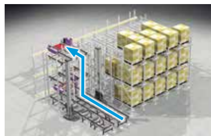
①パレットは入庫コンベヤから垂直リフター、ラック各段にあるシャトルへと搬送される。
