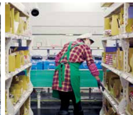
出荷頻度に合わせて、高頻度品は流動棚（写真左）、中頻度品は中量棚（写真中央）、低頻度品は「ジャングルカート」（写真右）というように、集品システムを組み合わせ eye-navi を運用している。
