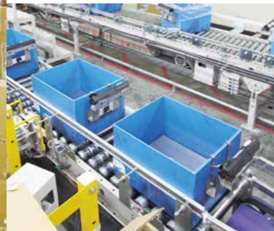
冷凍品専用の1ラインには分離しない循環式を採用。
