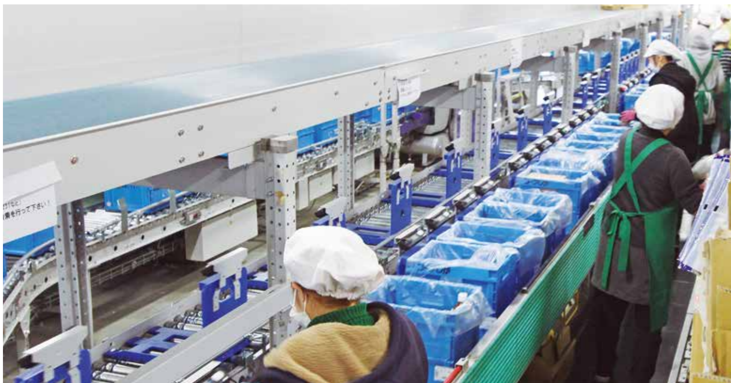
集品箱を隙間なく連続搬送する高能力デジタルピッキングシステム「eye-navi」。要冷品用の3ラインおよびドライ品・パン用の2ラインには集品箱と表示器が分離するトレー式を導入。
