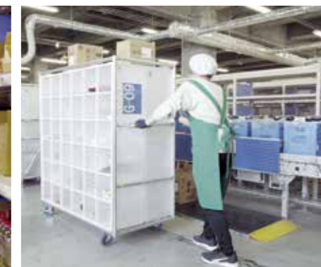
出荷頻度に合わせて、高頻度品は流動棚（写真左）、中頻度品は中量棚（写真中央）、低頻度品は「ジャングルカート」（写真右）というように、集品システムを組み合わせ eye-navi を運用している。
