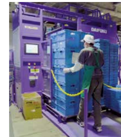
重労働だった出荷容器の積み付け作業を自動化。
