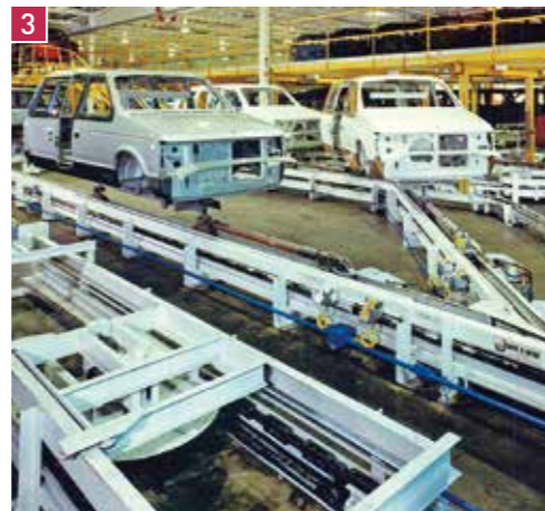
大手自動車メーカー工場で車体を搬送する「インバーテッドPower & Freeコンベヤ」。
