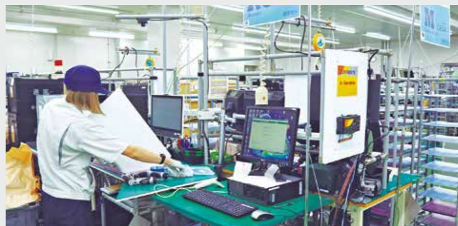
セル台車(作業棚)に人感センサを設置して、それぞれの作業状況をリアルタイムで把握。
