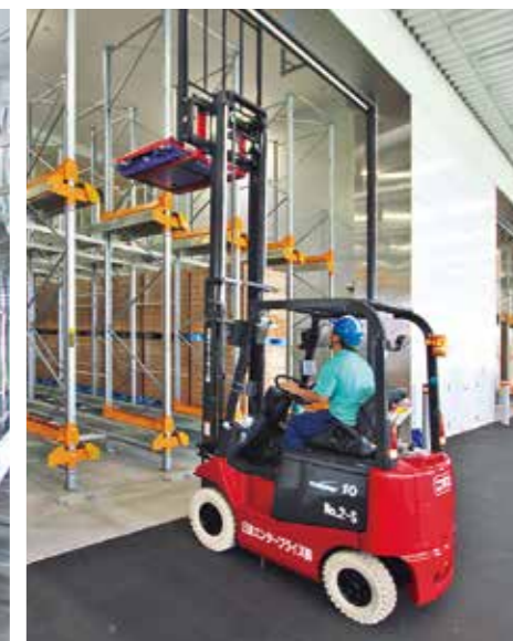
パレットを2段積みすることで、1間口にトラック1台分の商品を格納できる。格納数は2,588パレット。現在20台で運用しているシャトルは、フォークリフトを用いて作業する間口に運ぶ。
