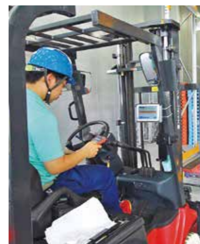
フォークリフトに取り付けた端末でシャトルに入庫や出庫指示を送信する。
