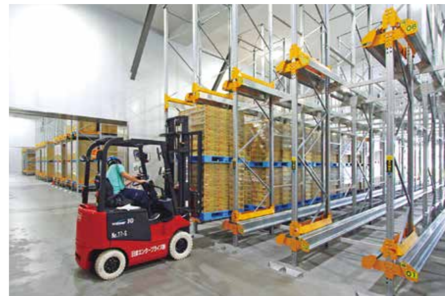
パレットを2段積みすることで、1間口にトラック1台分の商品を格納できる。格納数は2,588パレット。現在20台で運用しているシャトルは、フォークリフトを用いて作業する間口に運ぶ。
