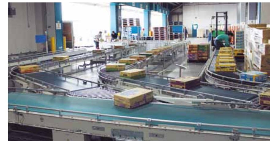
入荷ラインは4本。ベンダーでカテゴリー別に総量ピッキングした商品を投入する。
