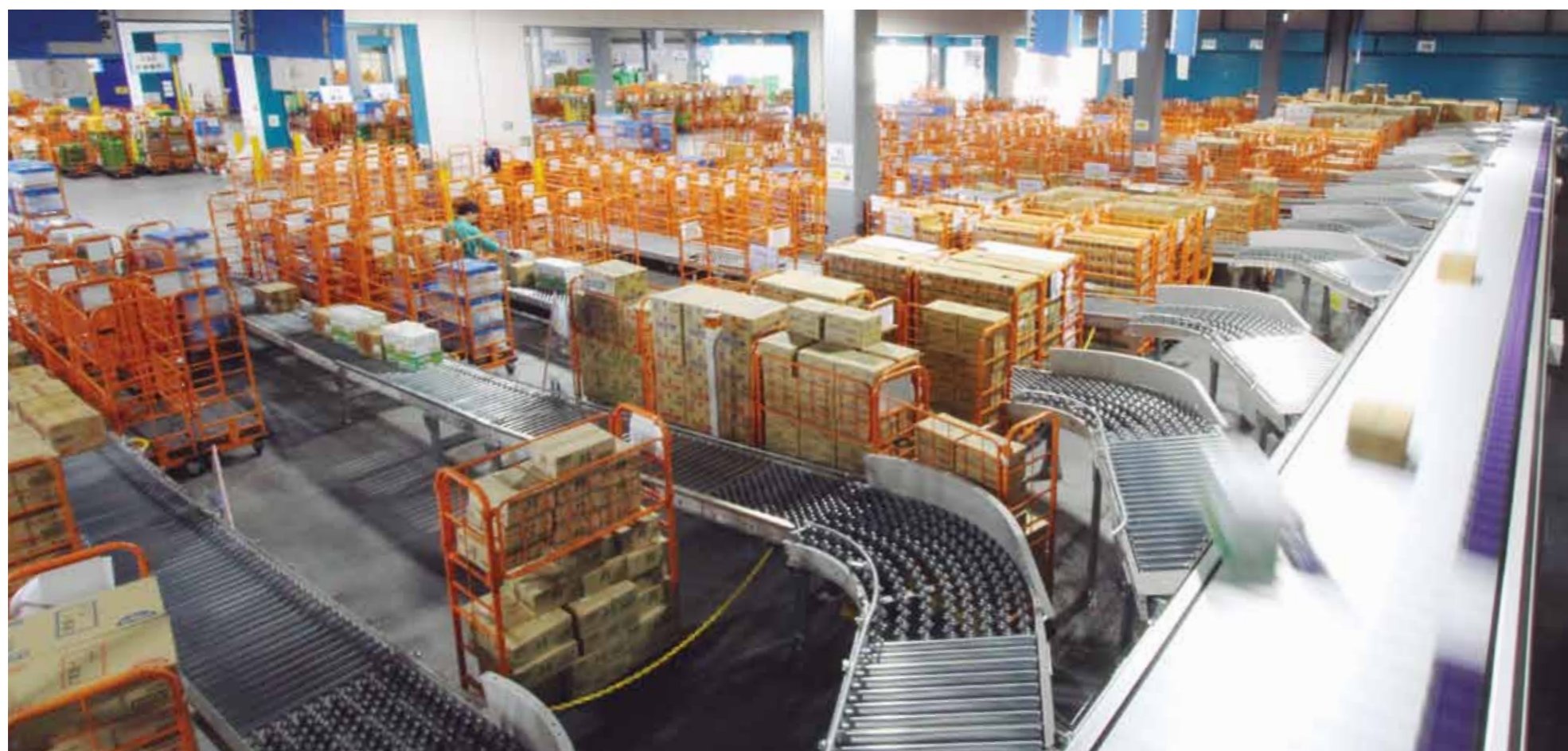
サーフィンソーターの全長は43m。リジェクトラインを含めて16シュートで構成され、最大4,000ケース/時を処理できる。
