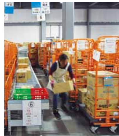
ソーターで仕分けた商品は店舗別にカートラックに積み込み、完了すると出荷エリアへ横持ちする。
