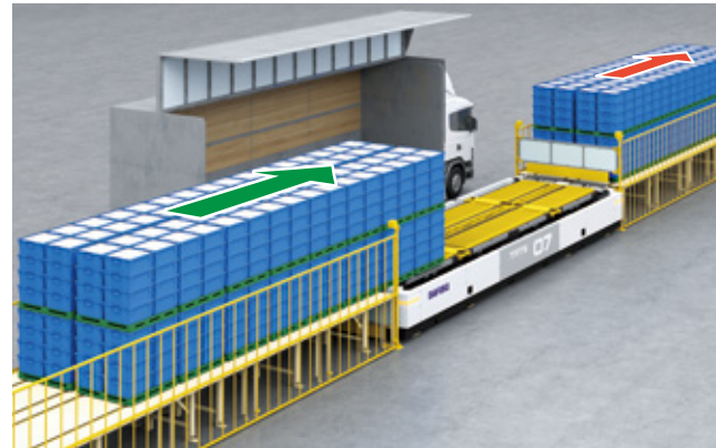
②入荷パレットをコンベヤへ払い出した後、出荷パレットを搬入。
