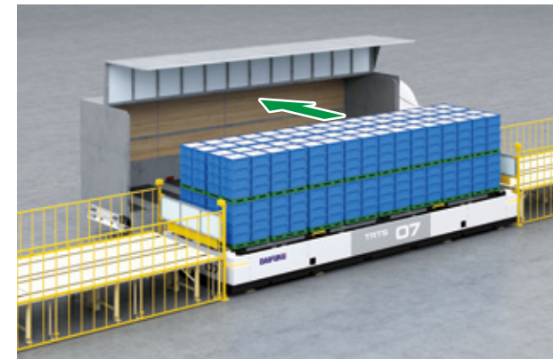
③荷降ろしと逆の動きで、自動で出荷パレットをトラックへ積み込み。*
