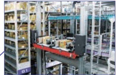
ケース自動倉庫 多種多様なサイズの段ボールケースを保管
