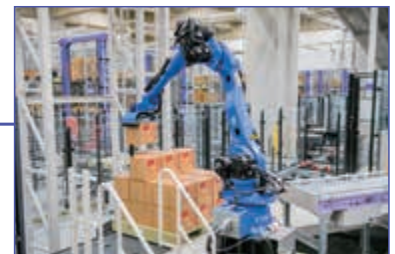
デパレタイズロボット 自動倉庫から出庫されたパレット上の段ボールケースをピッキング
