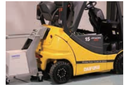
(写真2) 電動フォークリフト向け非接触充電システム「D-PAD」
